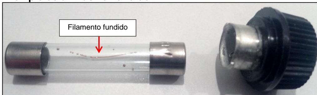
**Observação:** Quanto mais elevado for o calibre do fusível tanto maior é a secção do filamento. Consoante a intensidade do curto-circuito, o filamento pode ficar simplesmente seccionado.
