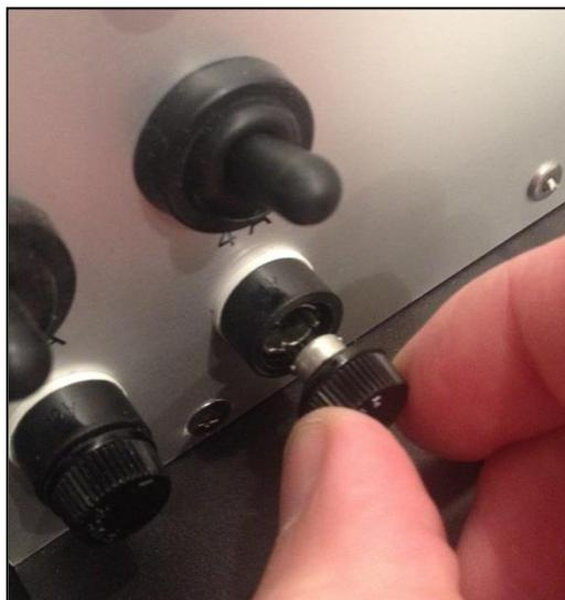
Os porta-fusíveis 15 e 16 são do tipo baioneta e abrem-se girando-os um quarto de volta.
