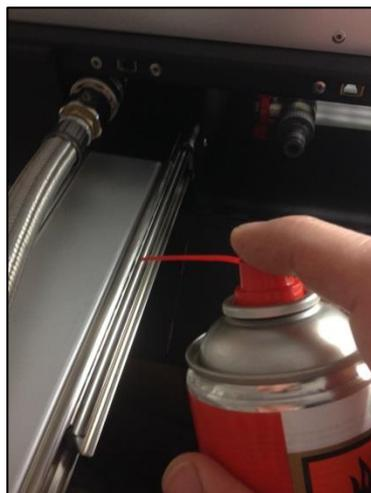
Os trincos dos três postigos devem ser lubrificados com massa de silicone em *spray*. Assim, garante o seu bom funcionamento e protege-os da humidade. Dirija bem o jato para as duas esferas de cada trinco. Esta operação deve ser efetuada quando guardar o aparelho e antes de voltar a utilizá-lo.
