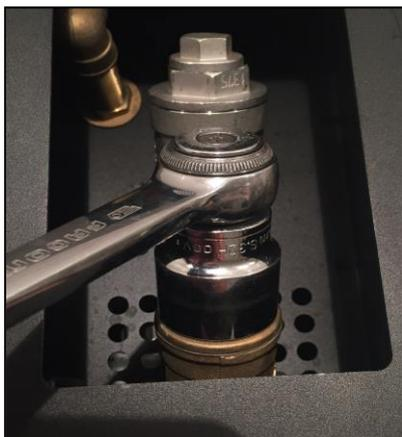
Desaparafuse a tampa do pré-filtro com uma chave sextavada (32 mm).
