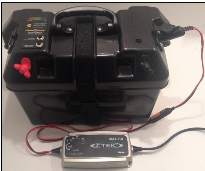
Kit opzionale di alimentazione. Composto da una scatola contenente una batteria di alimentazione, completa di tutti i connettori necessari e di un indicatore di carica. Dotato di caricatore automatico. **Contattateci per ulteriori informazioni.**
