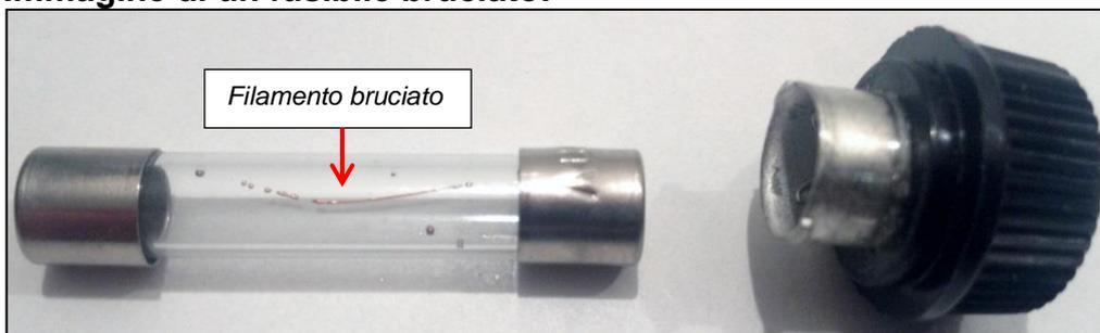
**Nota:** Maggiore è la resistenza del fusibile, maggiore è la sezione del filamento interno. A seconda dell'intensità del cortocircuito, il filamento può risultare semplicemente spezzato.
