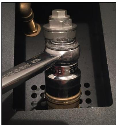
Svitare l'alloggiamento del pre-filtro mediante una chiave esagonale a tubo (32mm).
