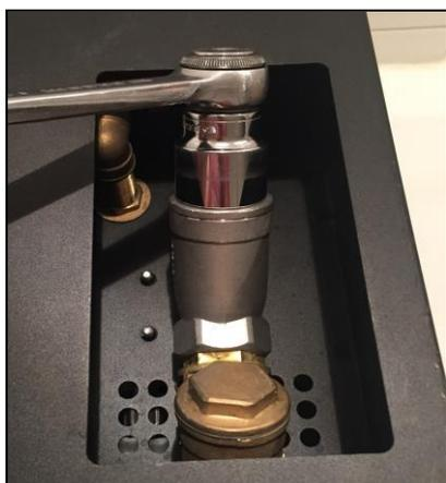
Svitare l'alloggiamento del filtro mediante una chiave esagonale a tubo (30mm).
