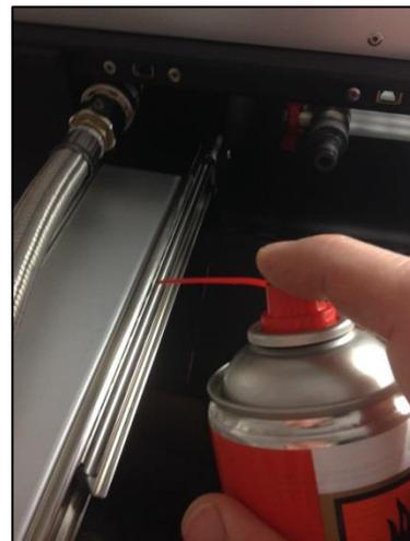
Le chiusure a scatto dei tre sportelli vanno lubrificate con grasso siliconico spray. Questo garantisce un funzionamento ideale, proteggendo dall'umidità. Ingrassare bene con il getto i due componenti di ogni chiusura. Questa operazione va effettuata al momento di riporre l'apparecchio, e prima di rimetterlo in servizio.
