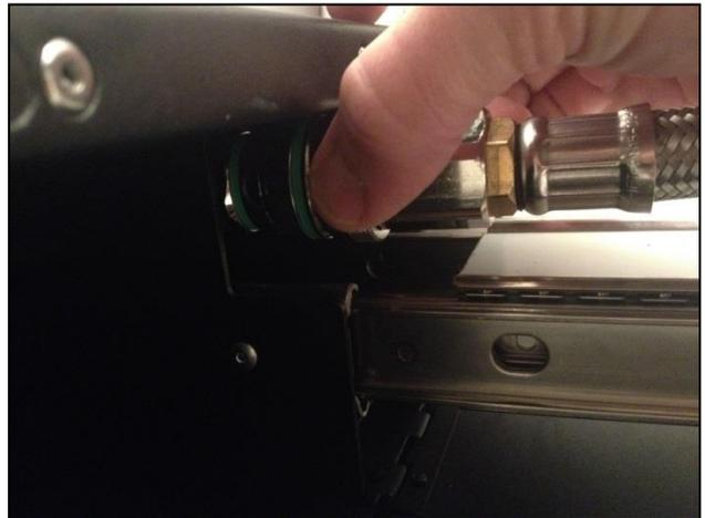
**Trennen:** Ziehen Sie den Anschlussring zu sich hin und trennen Sie die beiden Elemente.
