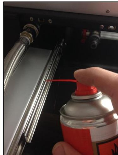
Auch die Sicherheitsriegel der drei Klappen müssen mit dem Silikonfett-Spray eingefettet werden. So lassen sie sich leichter bedienen und werden vor Feuchtigkeit geschützt. Richten Sie den Sprühstoß genau auf die beiden Rollen der Verriegelungen. Dies sollte beim Einlagern des Geräts und vor der Wiederinbetriebnahme erfolgen.
