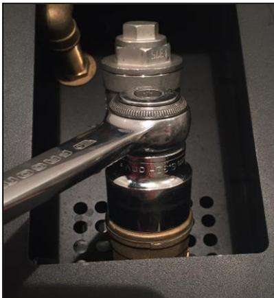
Schrauben Sie die Glocke des Vorfilters mit einem Sechskant-schlüssel (32 mm) ab.
