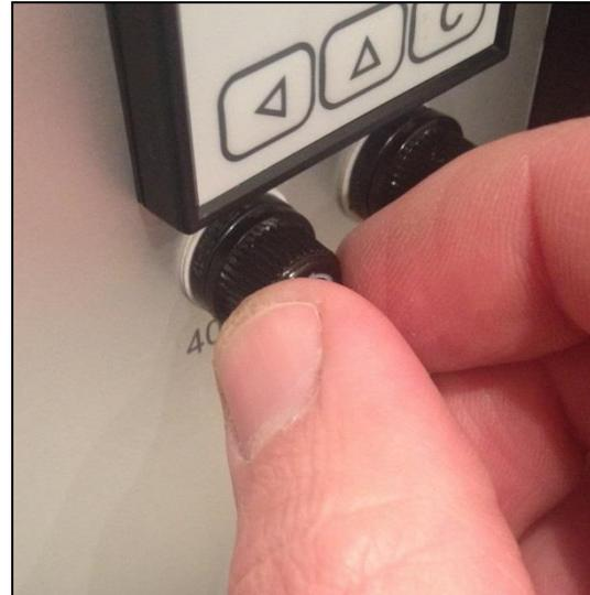
Die Sicherungshalter 17 und 18 sind Schrauben-Sicherungshalter, sie lassen sich abschrauben (gegen den Uhrzeigersinn).
