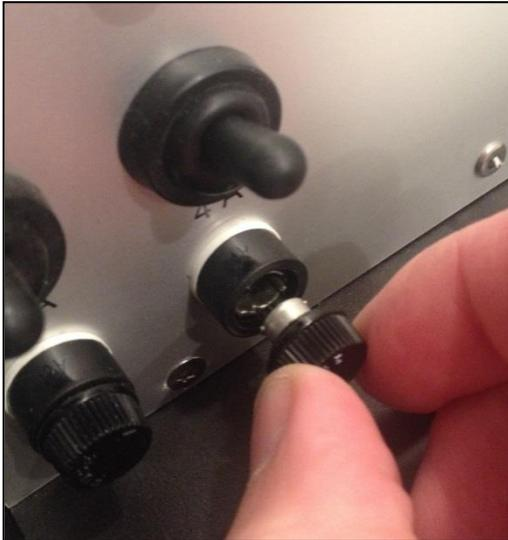
Die Sicherungshalter 15 und 16 sind Bajonett-Sicherungshalter, sie lassen sich durch eine Vierteldrehung öffnen.
