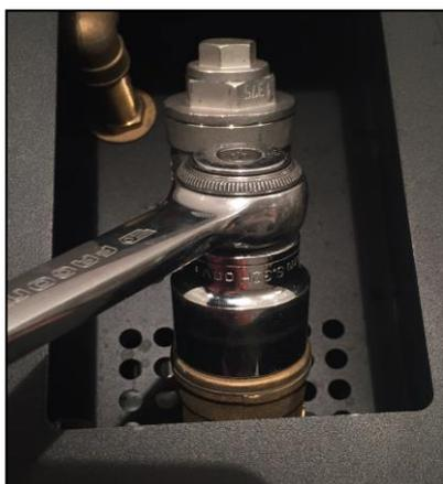
Dévissez la cloche du préfiltre à l'aide d'une clé à douille à 6 pans (32mm).
