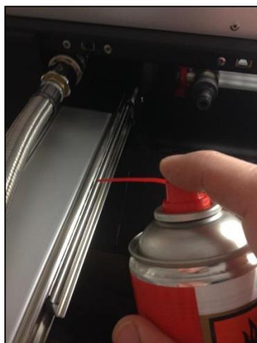
Les loqueteaux de verrouillage des trois volets doivent être lubrifiés avec de la graisse aux silicones en spray. Cela assure un fonctionnement aisé et les protège de l'humidité. Ciblez bien avec le jet les deux billes de chaque loqueteau. Cette opération est à effectuer lors du remisage de l'appareil est avant sa remise en service.
